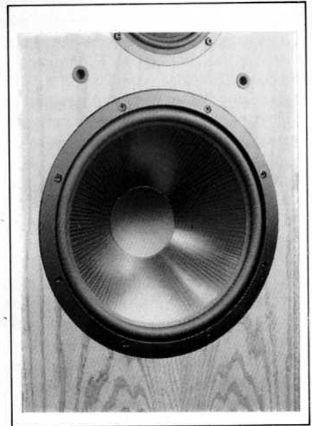
On remarque sur cette phono l'orientation des fibres dans un sens radial pour une rigidité exceptionnelle.
